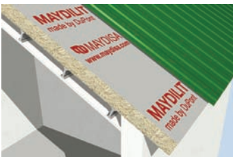
Colocación en cubierta de chapa
