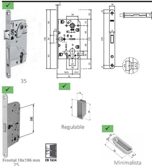
Cerradura magnética, especialmente indicada para puertas interiores de diseño moderno y líneas limpias. Incomparable versatilidad gracias al diseño innovador del cerradero que puede ser utilizado tanto para puertas lisas como solapadas, de madera o de aluminio. Polaris XT se distingue por el cierre completamente suave y silencioso, por el preciso ajuste y por la sensación de fluidez sentida tanto en la manilla como en la llave.
