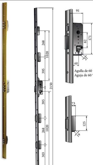
Cerradura de embutir con llave por la parte exterior e interior. Se componen de 3 puntos de cierre más golpe. Está realizada en chapa de acero de 2,5mm. Proporciona tanto al canto de la puerta como al marco, una gran robustez y fortaleza. El bombillo está protegido mediante un escudo que impide su manipulación.
