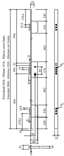
Cerradura ANTIPALANCA / Palancas de barras de acero / Picaporte reversible / 2 vueltas / Perfil: 25 x 6 mm. / Cilindros: DS-15 o K-20/ Entradas: 50 mm / Distancias: 85 mm. / Acabados del frente: cromo mate, dorado, negro, níquel satinado. / Escudos: 410-P / Cerraderos: Cortos Largos: 45 mm.
