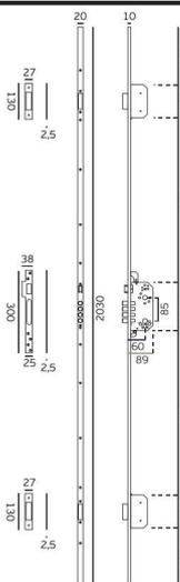
Cerradura de seguridad magnética. Nueca en acero inox. con muelle interior para eliminar la holgura entre la manilla y la nueca, picaporte magnético metálico, bulones de seguridad en acero inox, agujeros para tornillos pasantes, frente en acero satinado de 20x10 mm , bulones superior e inferior con cierre automático.
