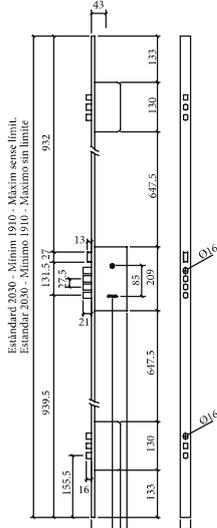
Cerradura de Alta Seguridad con Sistema de Gorjas de Doble Efecto / Cerradura central + 2 auxiliares / Palanca de barras de acero / Picaporte reversible / 2 vueltas / Cajas cerradas / Perfil 25 x 8 mm. / Entrada: 50 mm./ Acabados: Latón / Latón Cromado / Cerradero Largos 45 mm. / Escudo de seguridad.
