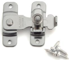
Ideal para entornos duros y de alta corrosión. El perno del pestillo encaja en el cerradero para evitar que se suelte accidentalmente. Al empujar la lengüeta del cerradero se libera el pestillo. Otras medidas disponibles. L=48 P=23±3 W=40
