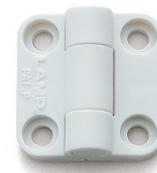
La bisagra de plástico sujeta la puerta en tres posiciones distintas sin soporte secundario (-10°, 120° y 170°). Se puede usar en aplicaciones en horizontal y vertical. Se recomienda un tope adicional en 0° y 170°. Ha superado con éxito la prueba de 40.000 ciclos de apertura/cierre
