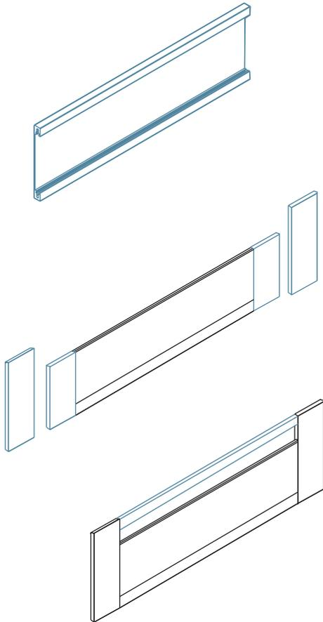
Perfil aluminio frontal de cajón interior. Perfil de 2 m. para corte a medida.
