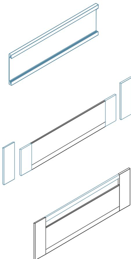
Perfil aluminio frontal de cajón interior. Perfil de 2 m. para corte a medida.
