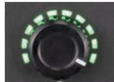
Regulación del caudal de aire mediante dial (38 - 120 m³/min)
