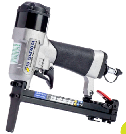
LU 8016 LAC Ref. M 150200 Grapadora grapa 80, de 6 a 16 mm. Morro llarg. Tapisseria, treballs de fusteria, ... Molt lleugera, mecanisme de bloqueig al gallet. Pressió d'ús 5 bar. Pvp 212,06 €
