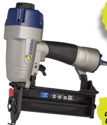
LNF 50AC Ref. M 080100 Clavadora clau 12, de 16 a 50 mm. Mobles, tanques, cases de fusta, embalatge, NO APTE PER A SÒCOL. Mecanisme de bloqueig al gallet. Pressió d'ús 5-6 bar. Pvp 200,72 €
