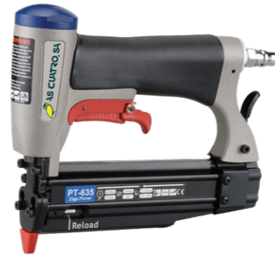
PT 635 Ref. M 030900 Clavadora clau 6, amb cap i sense, de 15 a 35 mm. Tapetes, llistons decoratius de mobles, NO APTE PER A SÒCOL. Molt lleugera, mecanisme de bloqueig al gallet. Pressió d'ús 5-6 bar. Pvp 235,87 €
