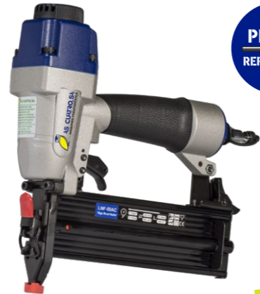
LNF 50AC Ref. M 080100 Clavadora clau 12, de 16 a 50 mm. Mobles, tanques, cases de fusta, embalatge, NO APTE PER A SÒCOL. Mecanisme de bloqueig al gallet. Pressió d'ús 5-6 bar. Pvp 200,72 €
