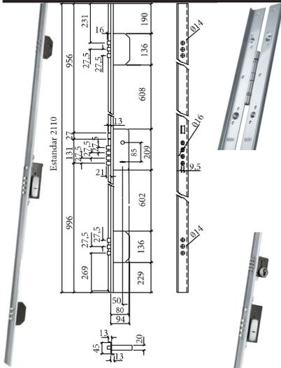
Cerradura de seguridad de tres puntos con bisagra antipalanca y travesaños de 1 mt. (posibilidad de travesaños de 1,20 mts). **Guarda mano.**
