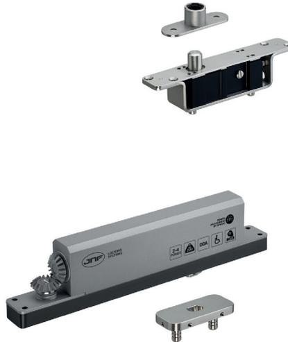
El CAM SYSTEM combinado con la hidráulica permite el control de cierre de grandes puertas batientes, abriéndolas con poco esfuerzo. Las puertas pueden ser de acción simple o doble, con espesores a partir de 40 mm. El sistema está oculto en el interior de la puerta, con solo una pequeña base en el suelo, con regulación bidireccional y un punto de rotación en el techo o marco superior de la puerta con rodamiento incorporado.
