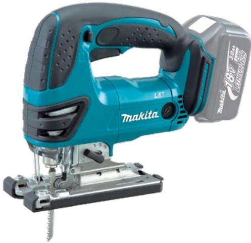
Eficiente sierra de calar con cambio de hoja sin herramientas Una sierra eficiente con acción pendular de tres etapas y cambio de hoja sin herramientas. La velocidad del motor se puede ajustar entre 0 y 2.600 min<sup>-1</sup> desde un interruptor para adaptarse al material. Una longitud de carrera de 26 mm y capacidad de corte de 135 mm en madera y 10 mm en acero.
