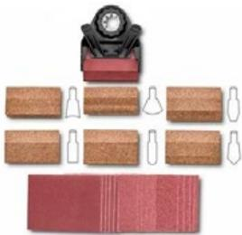
Set de 22 piezas para desbastar en ranuras y radios exteriores. Contenido: 1 soporte con 6 piezas insertadas perfiladas distintas. 1 forma V para ángulos de 90°, 1 forma trapezoidal para uniones machihembradas, 1 forma recta para perfiles, 1 forma convexa (grande), 1 forma cóncava y convexa (pequeña) y además 5 hojas de lija de cada uno de los granos 80, 120 y 180.
