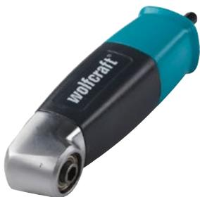
Vástago de 1/4" hexagonal (vástago ISO 1173 - E 6,3), fijación magnética hexagonal de 1/4"
