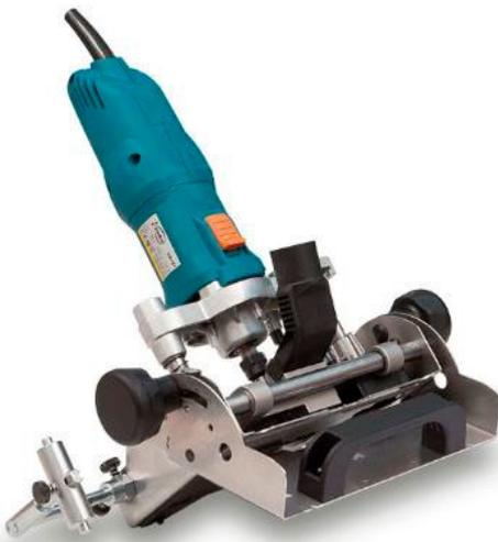
Fresadora especialmente diseñada para la realización de encajes para la colocación de conectores automáticos OVVO® para el ensamblaje de paneles. De uso práctico y cómodo, realiza el fresado fácilmente con rapidez y precisión. (Modelo Patentado) Potente motor de 1000 W con regulación electrónica de la velocidad y sistema electrónico para mantener la velocidad constante bajo carga. Escuadra regulable para fresados en diferentes ángulos.
