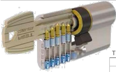
El modelo más veterano del catálogo. Solución económica, adecuada para accesos comunes. Gran fiabilidad y robustez en el uso. 5 pitones cargados a muelle. Se sirve con 3 llaves de acero niquelado . Amplia gama de medidas y modelos (botón, medio cilindro, etc.), cubriendo la reposición de cilindros para cerraduras como la 2000, 56-125...etc. Acabados: latón y níquel . Certificado según la norma EN-1303
