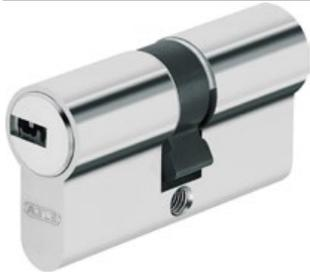
6 pitones combinados con contra-pitones anti-ganzúa. 5 llaves de puntos reversibles de latón cromado XL. Protección anti-taladro con contra-pitón de acero endurecido. Tarjeta de código de propiedad incluida. Muelles fabricados a partir de materiales no corrosivos. Leva de acero sinterizado para una buena resistencia contra la corrosión. Disponible en llaves iguales y otros grupos de llaves iguales. PS: pre-snap (rotura programada por ambos lados)
