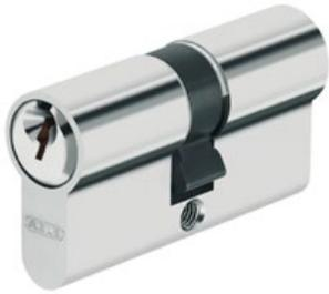
Cilindro para puertas de perfil europeo normalizado. Sistema de cierre con 5 pitones activos de latón técnica: Llave de serreta. Cuerpo y rotores de latón. Grapas de cierre de acero. Leva de acero sinterizado. Protección anti-taladro mediante contra-pitón de acero endurecido. 3 llaves de latón cromado. Disponible en acabados latón mate y níquel.
