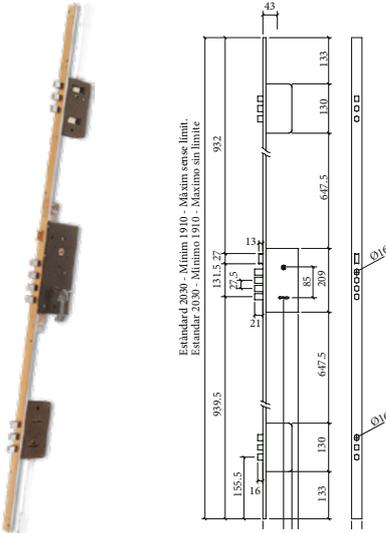
Cerradura de Alta Seguridad con Sistema de Gorjas de Doble Efecto / Cerradura central + 2 auxiliares / Palanca de barras de acero / Picaporte reversible / 2 vueltas / Cajas cerradas / Perfil 25 x 8 mm. / Entrada: 50 mm. / Acabados: Latón / Latón Cromado / Cerradero Largos 45 mm. / Escudo de seguridad.
