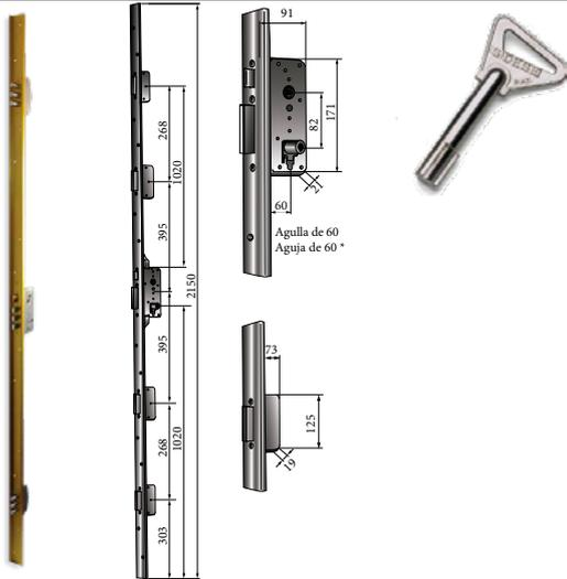
Cerradura de embutir con llave por la parte exterior e interior. Se componen de 3 puntos de cierre más golpe. Está realizada en chapa de acero de 2,5mm. Proporciona tanto al canto de la puerta como al marco, una gran robustez y fortaleza. El bombillo está protegido mediante un escudo que impide su manipulación.
