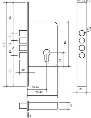
Cerradura ANTIPALANCA / Palanca de barras de acero / 2 vueltas / Perfil: 25 x 3 mm. / Cilindros: DS-15 / Entradas: 50 mm. Escudos: 410-P / Cerradero corto
