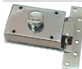
Cerrojo contrapalanca pomo interior, solo llave sin mano, cromada, escudo de latón macizo fijado al interior por 4 tornillos, cilindro de seguridad Inceca, protegido por casquillo giratorio anti-presa y con entrada de llave templada. 5 llaves. Caja de 122x85 mm. Cilindro de ø25 mm. Para puerta de 45 mm.
