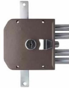
Cerradura de bulones golpe y llave con barras, acabado esmaltado. Para puerta de 45 mm. Bombin ø30 mm. Caja de 130x130x30 mm.
