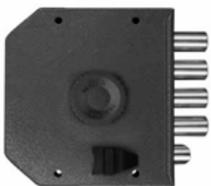
Cerradura de bulones golpe y llave, acabado esmaltado. Para puerta de 45 mm. Bombin ø30 mm. Caja de 153x143x30 mm.
