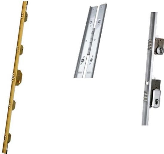
Cerradura ANTIPALANCA. Cerradura central + 4 frontales + 1 de servicio + 1 superior + 1 inferior. Palanca de barras de acero Ø16 mm. Picaporte reversible . 4 vueltas. Puntos de cierre superior e inferior. Cajas cerradas. Perfil Z: 40 /45 mm. Cilindros: DS-15 . Entrada: 72mm. Acabados: Cromo Mate Aluminio Plata Cerradero Angular Guarda mano.
