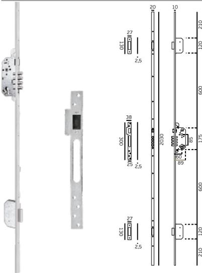
Cerradura de seguridad magnética. Nueca en acero inox. con muelle interior para eliminar la holgura entre la manilla y la nueca, picaporte magnético metálico, bulones de seguridad en acero inox, agujeros para tornillos pasantes, frente en acero satinado de 20x10 mm, bulones superior e inferior con cierre automático.
