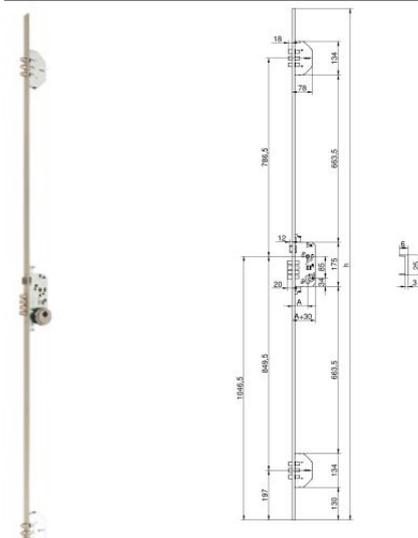
Cerradura de embutir para madera MCM 703-3 de 3 puntos de cierre y frente en U de 25x6mm. Cerradura central accionada mediante cilindro europerfil, con 4 bulones redondos y entrada de 50mm ó 60mm. Los bulones se proyectan 20mm a 2 vueltas. Medida entre ejes 85mm. Misma mecanización que la 2000B.
