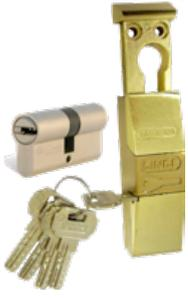
El cilindro está protegido totalmente al estar introducido dentro del cuerpo del protector no pudiéndose dañar desde el exterior. En caso de estar obstruido el orificio del protector, al introducir la llave se expulsa la silicona o cualquier otro cuerpo extraño que haya sido depositado, accediendo a su apertura. Este protector tiene la ventaja de accionarse con la llave del cilindro. Se suministra junto con el cilindro. Cilindro euoperfil 40+32 mm
