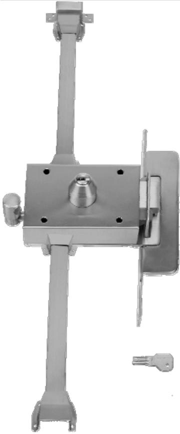
3 puntos de anclaje contrapalanca- doble bombillo. Golpe y llave, cromada, escudo de latón macizo fijado al interior por 4 tornillos, cilindro de seguridad Inceca, protegido por casquillo giratorio anti-presa y con entrada de llave templada. 5 llaves. Diámetro bombín ø25 mm. Para puertas de 45 mm. Caja de 80x120x30 mm.
