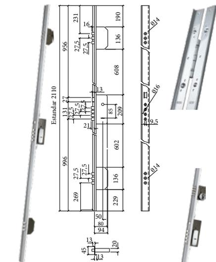
Cerradura de seguridad de tres puntos con bisagra antipalanca y travesaños de 1 mt. (posibilidad de travesaños de 1,20 mts). Guarda mano.
