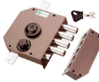
Cerradura 3 puntos de bulones golpe y llave, con barras ,acabado esmaltado y plata. Posibilidad de alturas de 2,03 a 2,65 mts. Grueso de puerta de 45 a 85 mm. Cilindro de ø30 mm. Caja de
