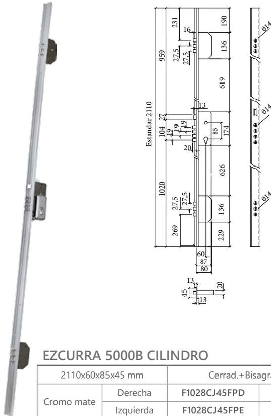
Cerradura de seguridad de tres puntos con bisagra antipalanca y travesaños de 1 mto (posibilidad de travesaños de 1,20 mts). Opcion de cerradero eléctrico.
