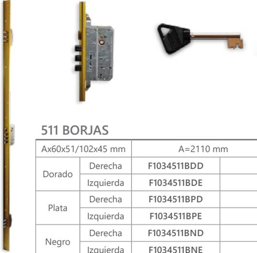
Conjunto antipalanca con 9 pestillos frontales accionados por la cerradura central de gorjas con 2 vueltas y picaporte. 5 llaves metálicas.
