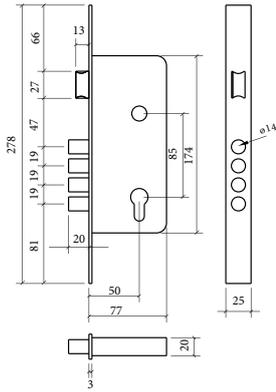
Cerradura ANTIPALANCA / Palanca de barras de acero / Picaporte reversible / 2 vueltas / Perfil: 25 x 3 mm. / Cilindros: DS-15 / Entradas: 50 mm / Distancias: 85 mm / Acabados del frente: Latón cromado / Cromo mate / Esmaltado Oro / Negro / Escudos: 410-P / Cerradero corto
