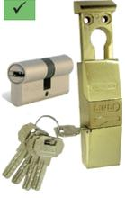
El cilindro está protegido totalmente al estar introducido dentro del cuerpo del protector no pudiéndose dañar desde el exterior. En caso de estar obstruido el orificio del protector, al introducir la llave se expulsa la silicona o cualquier otro cuerpo extraño que haya sido depositado, accediendo a su apertura. Este protector tiene la ventaja de accionarse con la llave del cilindro. Se suministra junto con el cilindro. Cilindro europerfil 40+32 mm
