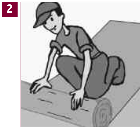
2 Extender el film de polipropileno Floover que sirve como protección de la humedad.
