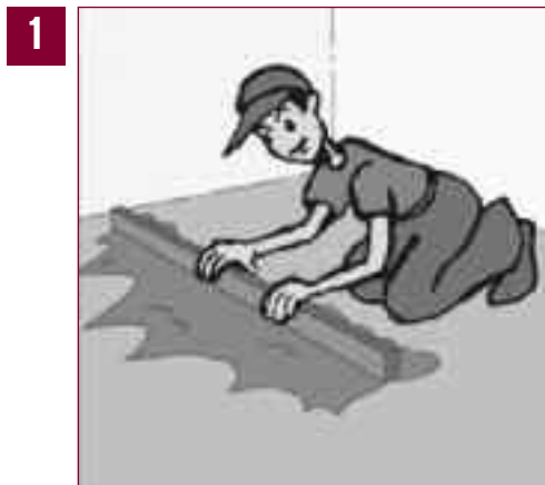
1 Nivelar el suelo para que los desniveles sean inferiores a 2mm
