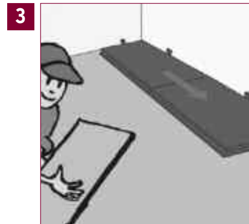
3 Colocar la primera fila de lamas siguiendo el sentido de la luz natural con distanciadores entre el muro y la primera fila dejando un espacio de 12mm. Encajar las lamas mediante el sistema UNICLIC.
